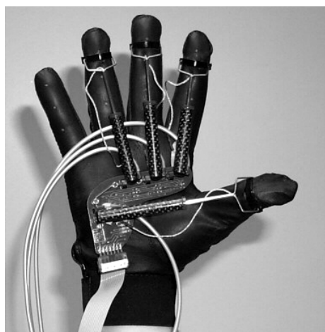
Рис. 9. Манипулятор-перчатка с силовой обратной связью
