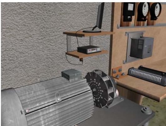
Рис. 15. Виртуальный стенд с асинхронным двигателем и преобразователем частоты в процессе "сборки"
